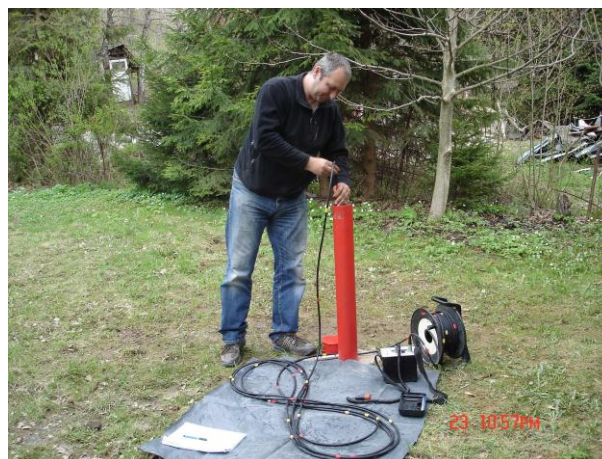
Obr. 6 Základné inklinometrické meranie na vrte RS-5
